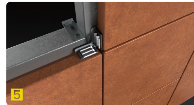
MZK클립 고정부위 모자이크패널 시공
